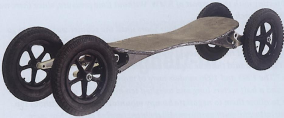
**Startschuss.** Mit einem Monstrum aus CFK startete 1995 die Entwicklung des Streetcarvers. Es maß noch über anderthalb Meter, wog zehn Kilogramm, die Räder hatten einen Durchmesser von 12,5 Zoll.
